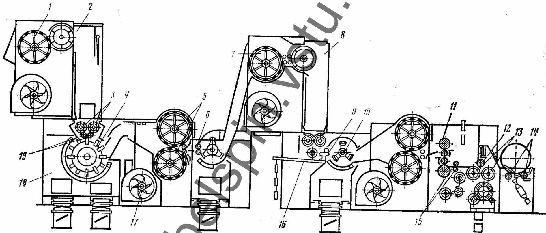
Рис. 1.11. Технологическая схема холстовой трепальной машины
