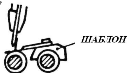
Рисунок 15 – Схема установки шаблона при регулировании величины погружения верхнего гребня
