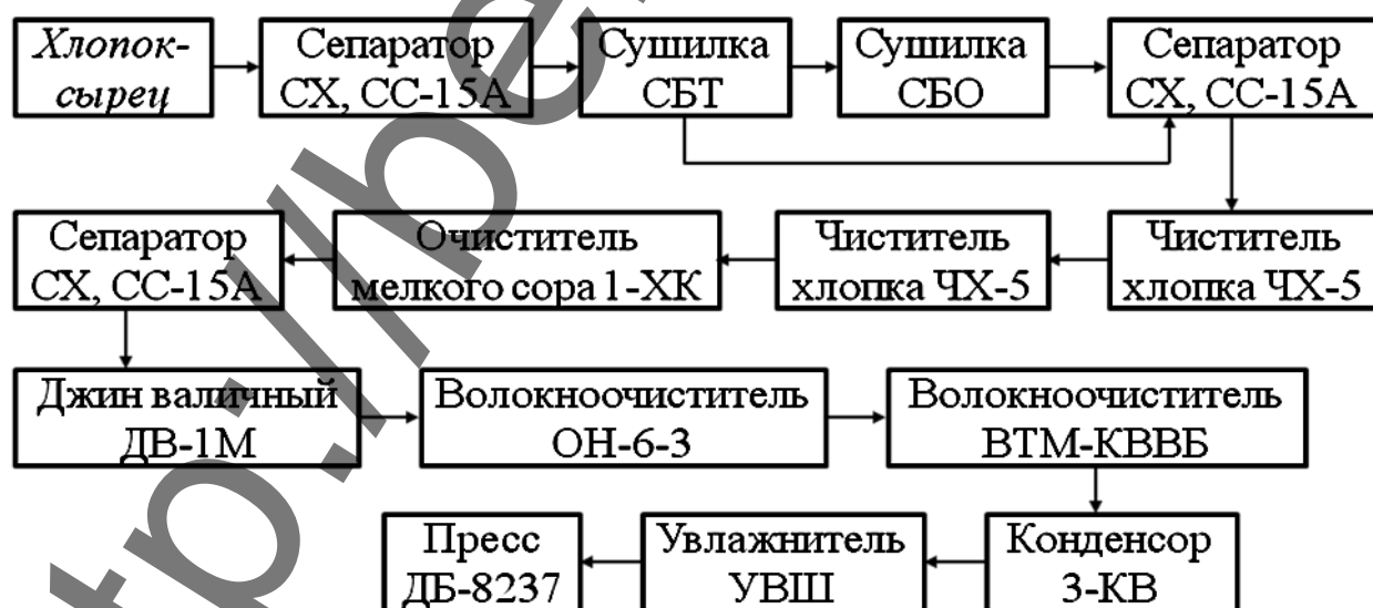
Рисунок 2 – Схема технологического процесса завода валичного волокноотделения
